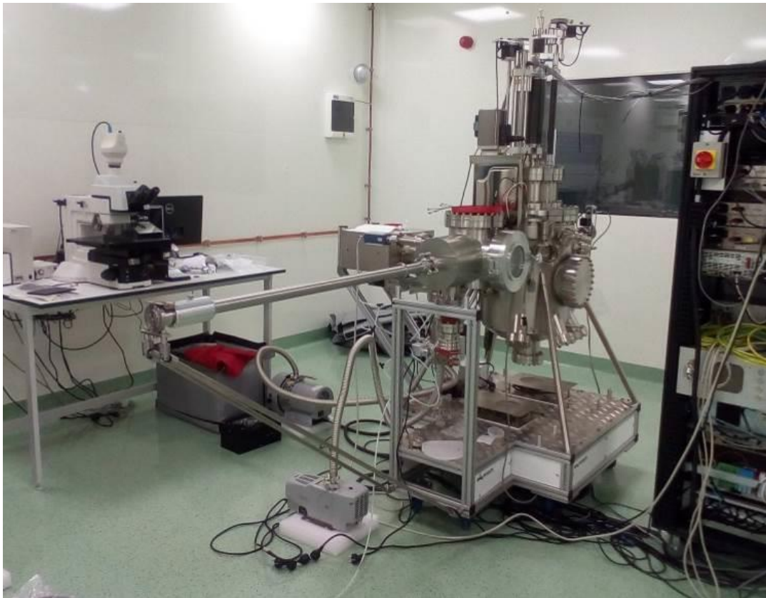
Instalatia pentru fabricarea de filme metalice (ultra) subtiri prin evaporare cu fascicul de electroni.
