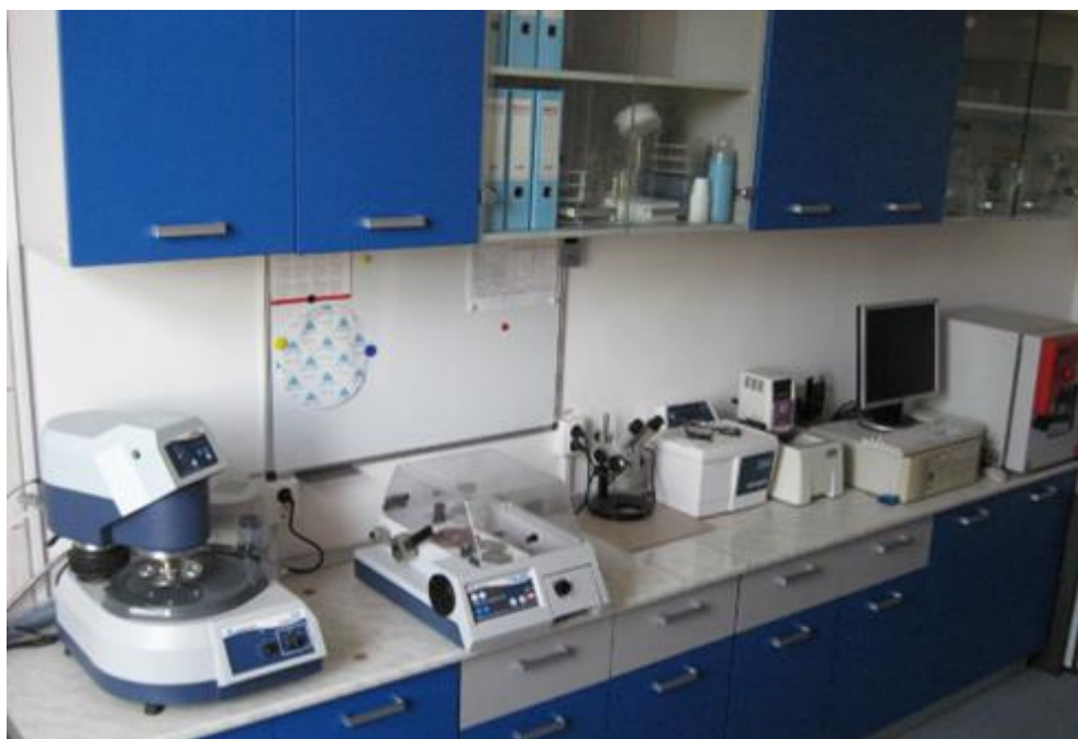
Echipamentele de taiere, slefuire si pregatire a probelor in vederea analizarii cu microscopul de forta atomica
