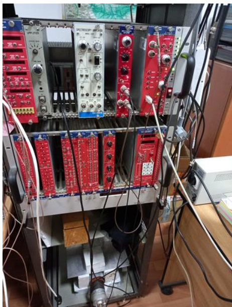
Structura experimentală pentru determinarea eficacității de detectare și a rezoluției energetice pentru cristalele de CsI(Tl) și NaI(Tl) (stânga); Detectorul de CsI(Tl) cu preamplificatorul sensibil la sarcină și protecția de plumb (dreapta)
